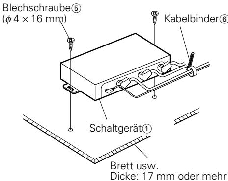
1. Installieren Sie das Schaltgerät mit Blechschrauben ⑤ ( $\phi 4 \times 16$  mm).
