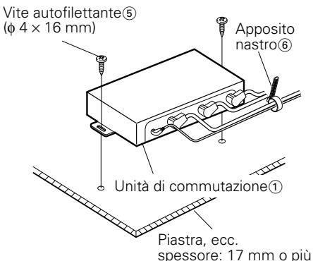
1. Installate l'unità di commutazione con le viti filettanti ⑤ ( $\phi 4 \times 16$  mm).
