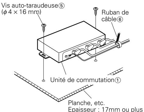
1. Installer l'unité de commutation avec les vis auto-taraudeuses⑤ ( $\phi 4 \times 16$  mm).
