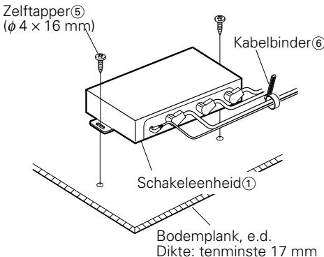
1. Installeer de schakeleenheid m.b.v. de zelftappers⑤ ( $\phi$  4 x 16 mm).
