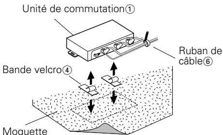
1. Retirer la bande de protection des bandes velcro ④ et le fixer sur le fond de l'unité de commutation①. Installer l'unité de commutation sur la moquette.
