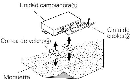
1. Extraiga el apoyo de la correa de velcro④ y fíjela a la parte inferior de la unidad cambiadora①. Instale la unidad cambiadora sobre la alfombra.
