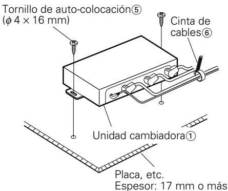
1. Instale la unidad cambiadora con los tornillos
