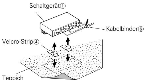
1. Entfernen Sie die Rückseite des Velcro-Strips Klebebandes ④ und befestigen Sie es unter der Schaltgerät ①. Installieren Sie das Schaltgerät auf dem Teppich.
