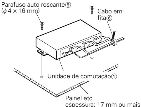
1. Instale a unidade de comutação com parafusos auto-rosantes⑤ ( $\phi 4 \times 16$  mm).
