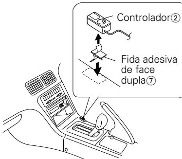
1. Limpe o local da instalação com um pano de limpeza.
